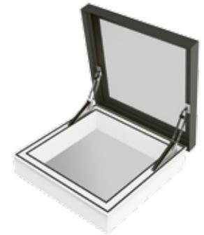
SkyVision ACCESS ist ein Flachdachoberlicht für RWA und Dachausstieg. Über einen Druckschalter oder Feueralarmschalter öffnet sich das Fenster bis zu einem Öffnungswinkel von 75°.
