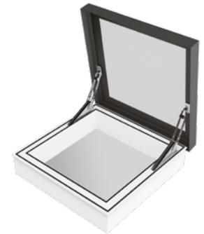
Das SkyVision ACCESS ist nicht nur ein Ausstiegsfenster, sondern dient ebenso als effizienter Rauchabzug. Über einen Druckschalter oder Feueralarmschalter öffnet sich das Fenster bis zu einem Öffnungswinkel von 75°.
